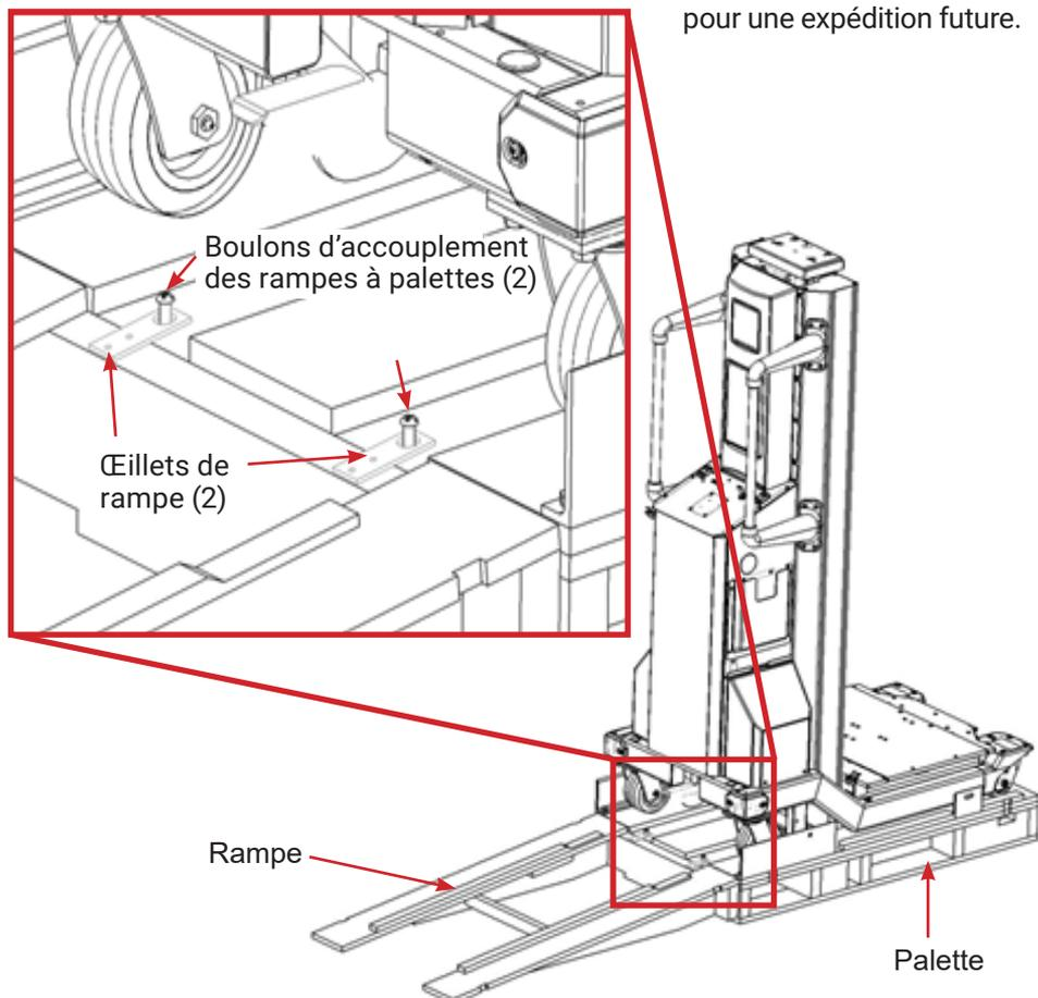
**Étape 5 :** Positionner la rampe contre l'extrémité de la palette. S'assurer que les œillets de rampe s'accrochent aux vis à palettes, comme indiqué ci-dessous.
